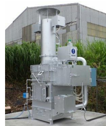
Forno de incineração de pequeno porte Chirimeser
